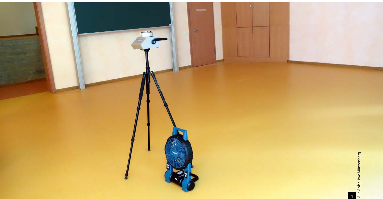
Abb. 1: Blick auf eine typische Messstation nach der Feinreinigung: Um den Erfolg einer Feinreinigung zu kontrollieren, hat sich als Methode für Raumluftmessungen die Gesamtsporenbestimmung durch Impaktion von Partikeln auf beschichtete Objektträger mit anschließender mikroskopischer Bestimmung nach DIN ISO 16000-20 bewährt. Vor der Messung werden die sedimentierten Partikel mit einem Handventilator mobilisiert.
