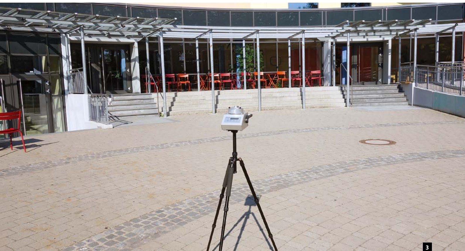
Abb. 3: Wie die Praxisanwendung der Partikelmessung zeigt, ist der Einfluss der Außenluftbelastung auf abgeschottete, gereinigte Sanierungsbaustellen erheblich geringer als bei genutzten, normal gelüfteten Räumen. Die Entnahme einer Außenluftprobe als Rückstellprobe kann insbesondere im Sommer dennoch nützlich sein, um bei ungewöhnlich hoher Belastung der Luft im Baustellenbereich mit typischen Außenluftsporen diese ergänzend analysieren zu können.
